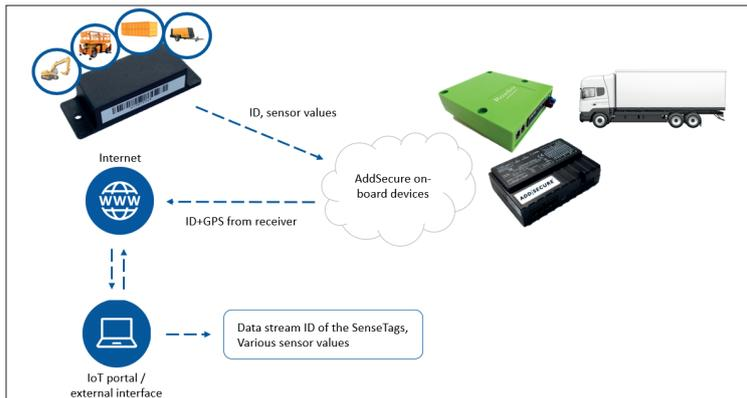
Der SenseTag kann flexibel an jegliche Art von Objekt angebracht werden. Durch Bluetooth 4.0+ wird eine 5-jährige Batterielaufzeit erreicht und das Gerät dient als Datenlogger.
